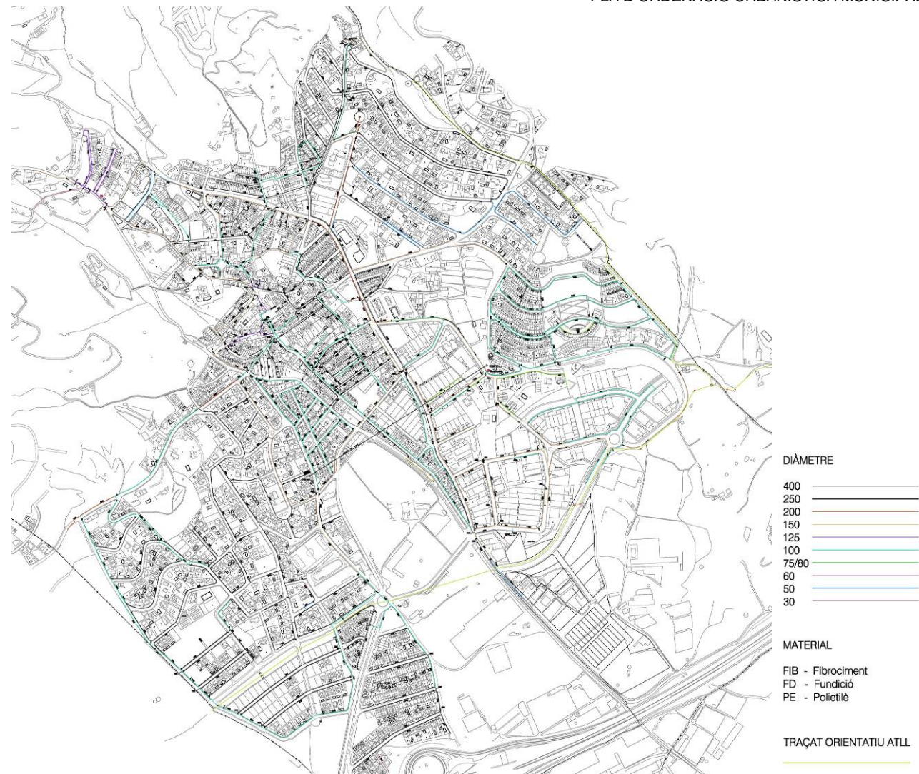
Figura 3.2: Esquema de la xarxa d'abastament actual d'aigua potable. Font: Ajuntament de Vilassar de Dalt.
