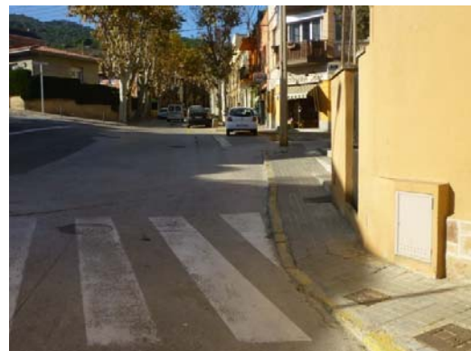
Imatge 52. Alineació irregular de la vorera que amplia la zona central de la cruïlla com a espai de ningú.
