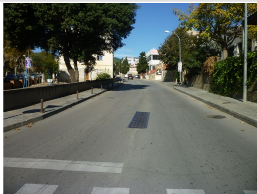
Imatge 72. Riera Targa sense marques de separació de carrils que convida a córrer.
